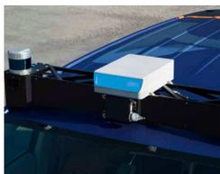
Aurora a introduit son FirstLight LiDAR sur ses véhicules d'essai de nouvelle génération. La société affirme qu'il aide le système de perception à voir et à suivre les objets plus loin, plus rapidement et avec une plus grande précision.
