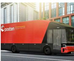
Avec le Volta Zero, le constructeur Volta Trucks a concrétisé son objectif de concevoir « le premier grand véhicule urbain de distribution de fret entièrement électrique à partir d'une feuille blanche ». La cabine vitrée, le siège centré du conducteur et les caméras et capteurs de mouvement assurent la sécurité des usagers de la rue qui l'environnent. Selon le constructeur, ses nombreuses batteries placées dans le plancher assurent au Volta Zero une autonomie de 150 à 200 km.
