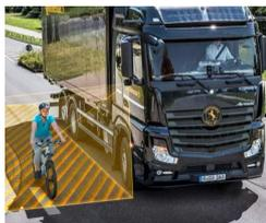
Le système d'aide au virage développé par Continental augmente considérablement la sécurité en avertissant le conducteur du véhicule utilitaire dès qu'un piéton, un cycliste ou un conducteur de scooter se trouve dans l'angle mort à côté du bus ou du camion. D'ici 2024, des systèmes de ce type deviendront progressivement obligatoires sur tous les nouveaux camions dans l'UE.
