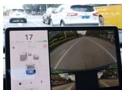
Auparavant, Tesla utilisait déjà les caméras latérales pour détecter si quelqu'un se trouvait dans l'angle mort, et avertissait le conducteur en cas de danger. Désormais, le conducteur pourra voir l'angle mort de ses propres yeux.
