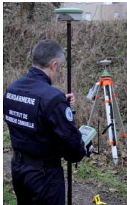
Figure 6. Exemple de levé codé par GNSS
